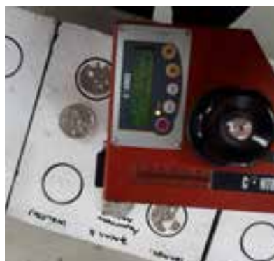
Испитување на адхезија на заштитните премази Pull-off метода
