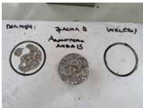
Испитување на адхезија на заштитните премази Pull-off метода
