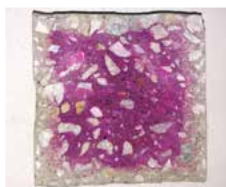
Испитување на длабочина на карбонизација
